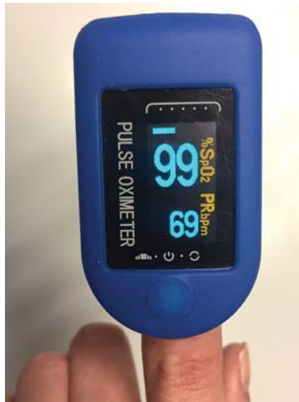
Abb. 1: Pulsoximeter sind mittlerweile relativ preisgünstig zu erwerben, mit der Messung von Sauerstoffkonzentration und Herzfrequenz helfen sie schnell bei der Einschätzung des Zustandes eines Notfallpatienten
