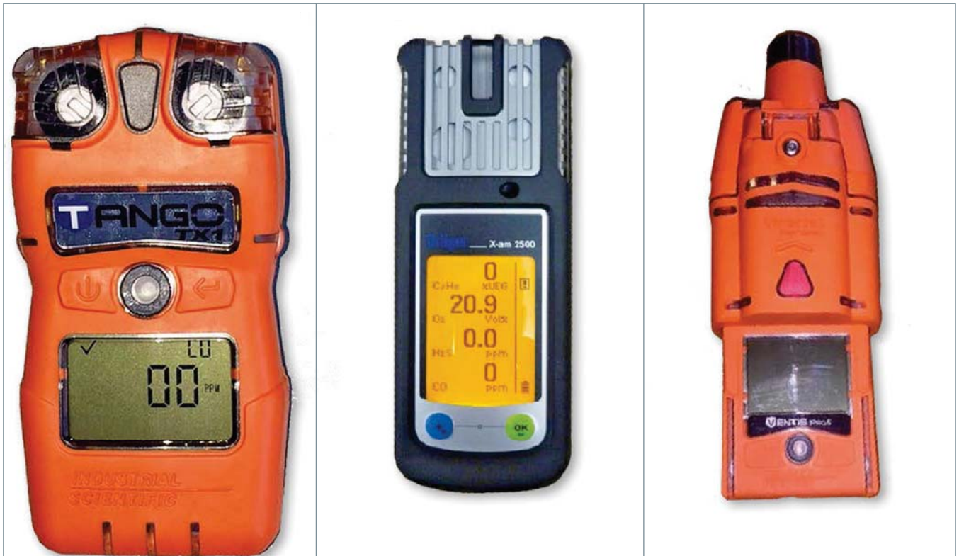
Zur Eigensicherung empfiehlt sich die routinemäßige Anwendung von Ein- oder Mehrgasmessgeräten.
