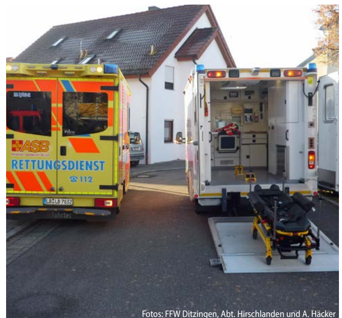
Abb. 3: Schwerlast-Rettungswagen (rechts) verfügen über die erforderliche Stabilität und Sicherungsmöglichkeiten sowie eine Ladebordwand
