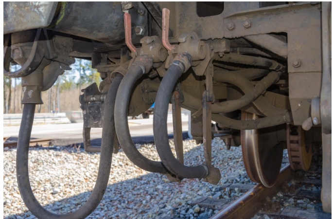
Abbildung 35: Luftleitungen mit Luftabsperrröhnen
