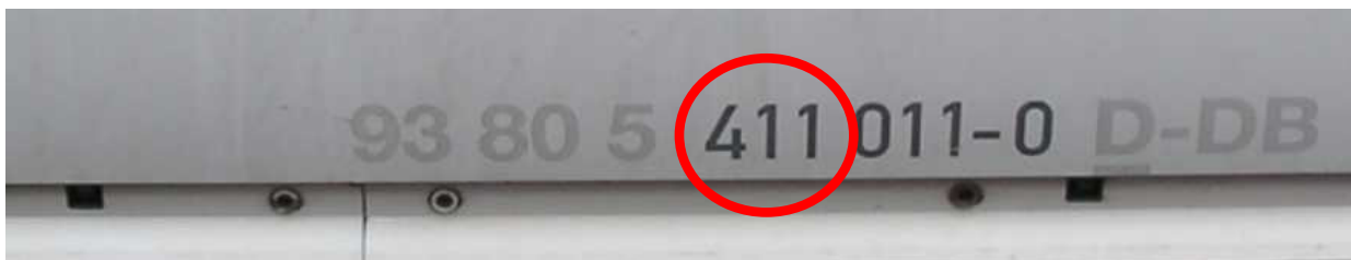
Abbildung 28: Zwölfstellige Fahrzeugnummer mit Baureihe
