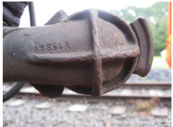
Abbildung 36: Gekennzeichneter Luftkopf einer Hauptluftbehälterleitung
