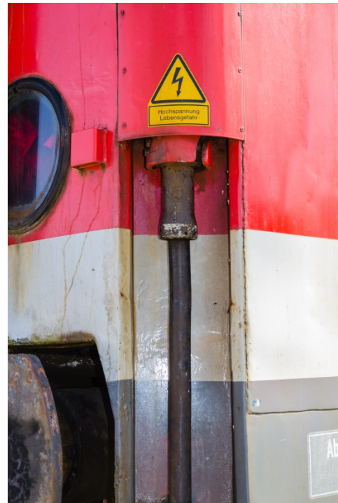
Abbildung 37: Nicht verbundene Zugsammelschiene an einem Reisezugwagen
