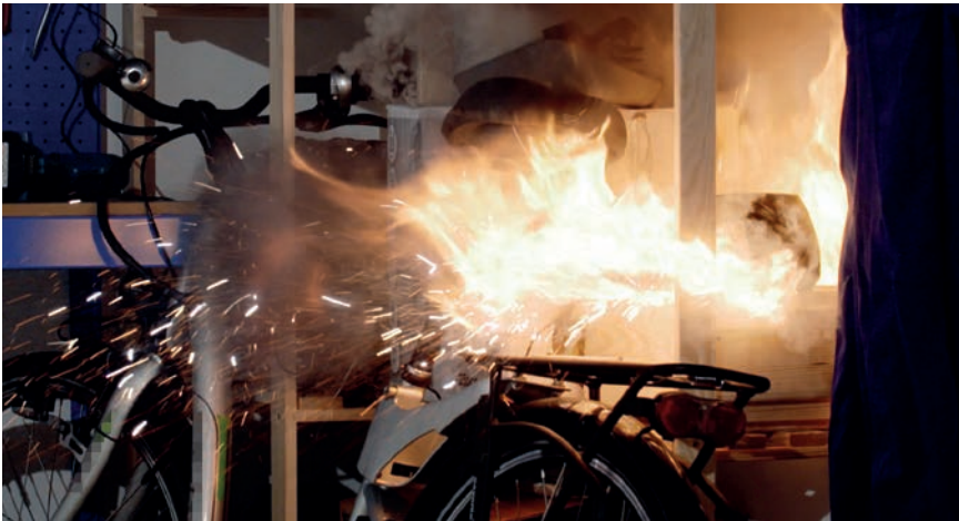
Ein Fahrradakku geht beim Ladevorgang thermisch durch.
