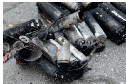
Die Reste eines Fahrradakkus: Einige der Zellen sind aufgeplatzt. Foto: IFS
