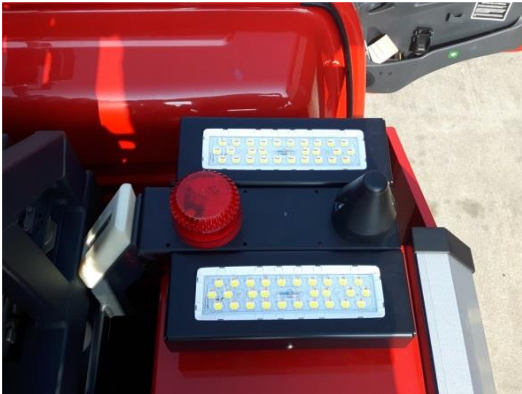
Erkundungsscheinwerfer in Kombination mit Blitzleuchte der Spannungswarnerichtung an einem Hubrettungsfahrzeug der Feuerwehr Oberhausen.
