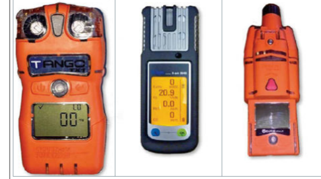
Zur Eigensicherung empfiehlt sich die routinemäßige Anwendung von Ein- oder Mehrgasmessgeräten.
